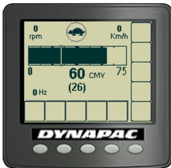
Fig. Pantalla del medido de compactación (pantalla CMV)
