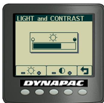
Réglages des paramètres d'éclairage et de contraste de l'affichage, ainsi que de la luminosité de l'éclairage du panneau.
