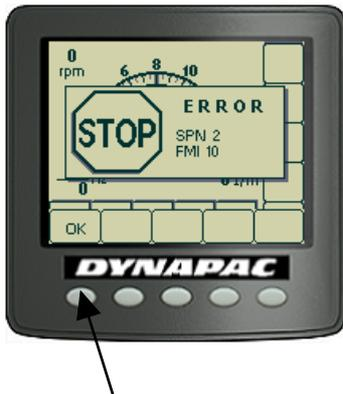
Lorsqu'une alarme de défaillance moteur se déclenche, elle apparaît sur l'écran.
