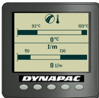
Fig. Température de l'asphalte/Écran de l'impacteur
