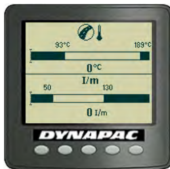
Fig. Fereastră pentru temperatura asfaltului/impactometru
