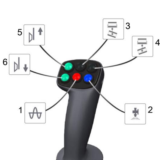
Fig. Palanca de avance y retroceso
