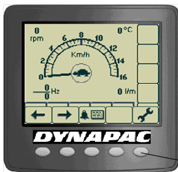
Fig. Pantalla principal/Pantalla de trabajo con los botones de selección de menú (1)
