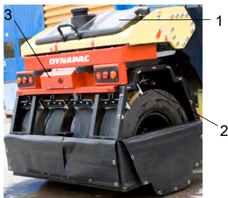
Fig. Hjulophæng 1. Bageste vandtank 2. Sprinklerdyse 3. Sprinklersystem
