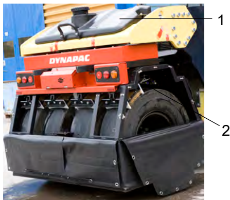
Fig. Hjulophæng 1. Bagerste vandtank 2. Sprinklerdyse
