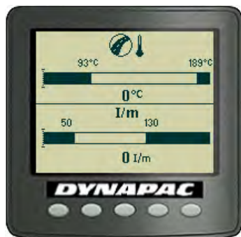
Fig. Skærm for asfalttemperatur/impaktometer
