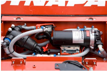
Pour purger le réservoir, ouvrir la vanne par le tuyau du diviseur.
