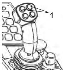
Рис. Рычаг прямого/обратного хода
