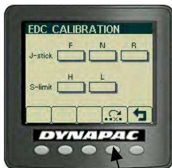
«EDC CALIBRATION» (Калибровка электронного управления)
