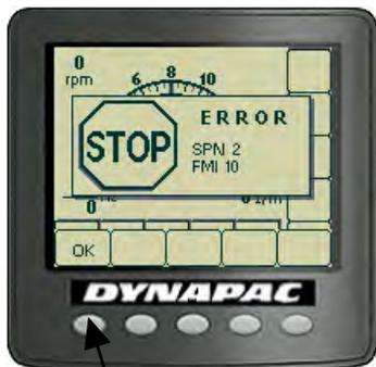
При возникновении аварийного сигнала, касающегося работы двигателя, на дисплее отображается предупреждение.
