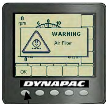
При возникновении аварийного сигнала, касающегося работы машины, на дисплее отображается предупреждение с информацией в виде текстового сообщения.
