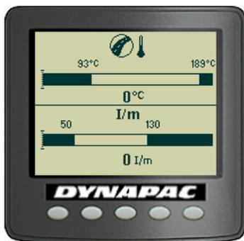
Fig. Temperatura del asfalto/Pantalla del impactómetro
