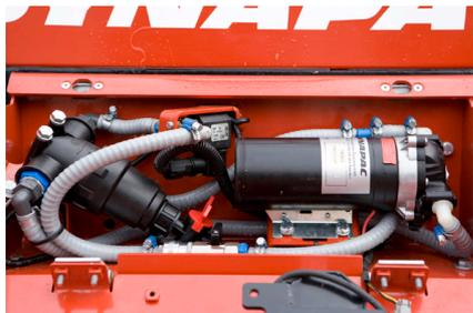
Para drenar el depósito abra la válvula por la manguera del divisor.
