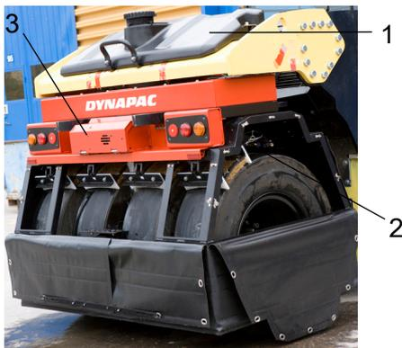
**Fig. Bastidor de ruedas**
