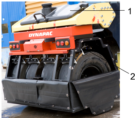
Fig. Hjulställ 1. Bakre vattentank 2. Sprinklermunstycke
