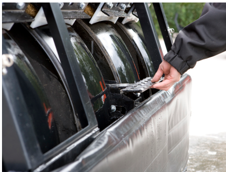
Fig. Hjulställ 1. Bakre vattentank 2. Sprinklermunstycke
