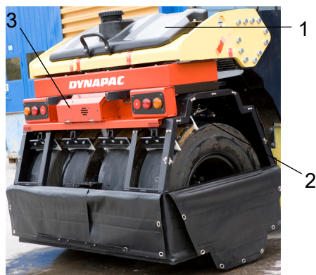
Fig. Hjulställ 1. Bakre vattentank 2. Sprinklermunstycke 3. Sprinklersystem
