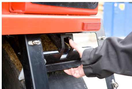
Fig. Däckskrapor 1. Skrapblad 2. Låskrok
