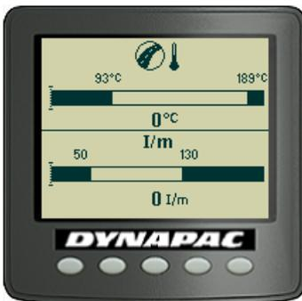
Fig. Température de l'asphalte/Écran de l'impacteur
