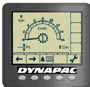
Abb. Das Display zeigt die gewählte Position in der Mitte (Position 1, 2 oder 3)
