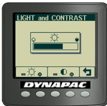
Regolazione delle impostazioni di luminosità e contrasto sul display, compresa la luminosità dell'illuminazione del pannello.
