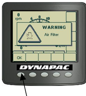
Quando viene attivato un allarme macchina, esso viene visualizzato sul display accompagnato da un testo di avvertenza che lo descrive.
