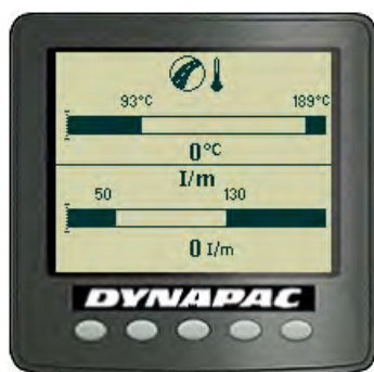
Rys. Temperatura asfaltu/Ekran uderzeniometra
