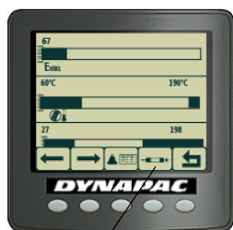
Рис. Измеритель уплотнения Evib (DCM Evib), температура асфальта, измеритель частоты ударов 1. Измеритель уплотнения Evib (DCM Evib) 2. Температура асфальта 3. Значение измерителя частоты ударов
