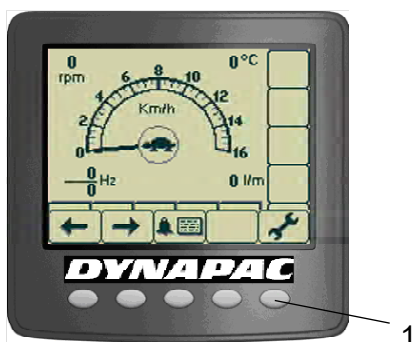
Fig. Pantalla principal/Pantalla de trabajo con los botones de selección de menú (1)
