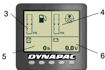
Fig. Pantalla de estado 3. Nivel de combustible 4. Nivel de agua 5. Medidor horario 6. Voltímetro
