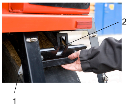
Fig. Racleurs de pneus 1. Lames de racleur 2. Crochet de verrouillage
