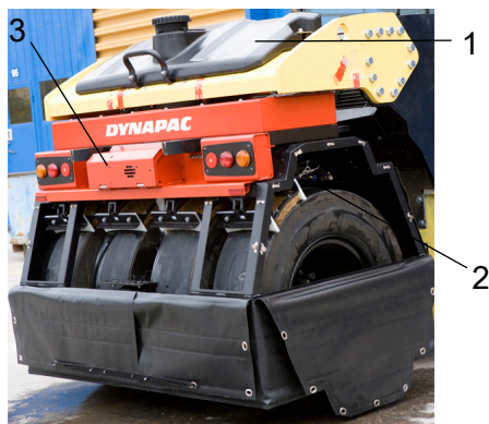
Fig. Support de roue 1. Réservoir d'eau arrière 2. Buse d'aspersion 3. Système d'aspersion
