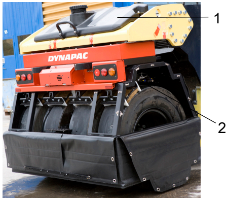
Fig. Support de roue 1. Réservoir d'eau arrière 2. Buse d'arrosage
