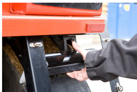
Fig. Racleurs de pneus 1. Lames de racleur 2. Crochet de verrouillage
