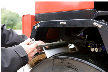
Lors de la remise en place après inspection, etc., le racleur doit d'abord être fixé dans le crochet de verrouillage avant que l'axe de raccordement soit mis en position.
