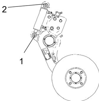
Figure. Deux points de graissage pour lubrifier le coupe-bordure.
