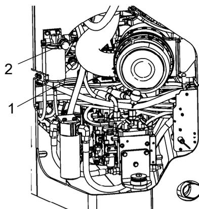
**Figure. Filtre à carburant**
