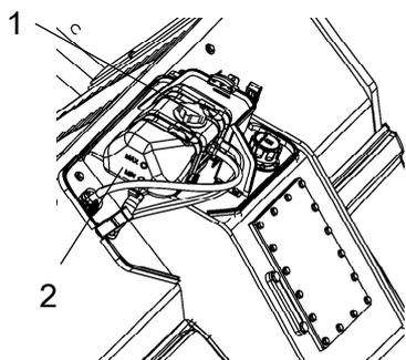
**Fig. Réservoir d'expansion**
