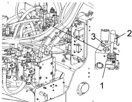
**Fig. Soupape pour neutraliser les freins**
