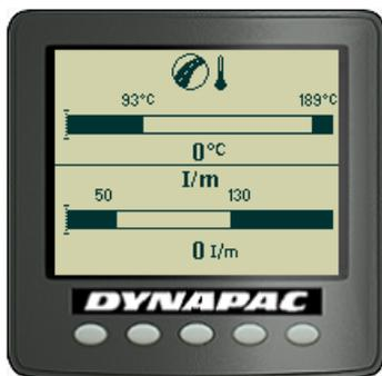
Fig. Température de l'asphalte/Écran de l'impacteur
