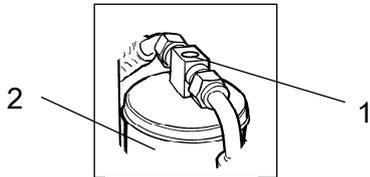
Figure. Filtre de séchage
