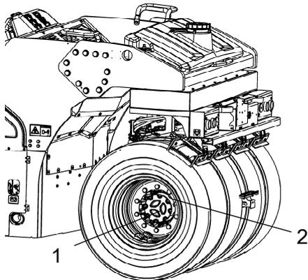
**Fig. Contrôle du niveau d'huile - Engrenage à roue**
