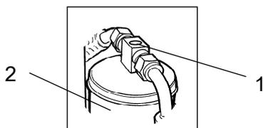
Figure. Filtre de séchage
