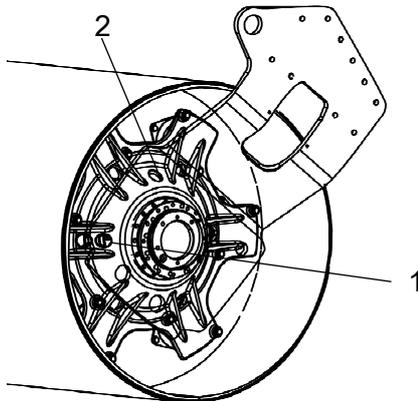
**Fig. Contrôle de niveau d'huile - engrenage de cylindre**
