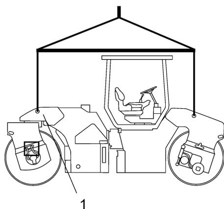
**Fig. Rouleau prêt au levage**
