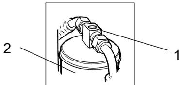
Figure. Filtre de séchage
