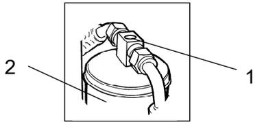
Figure. Filtre de séchage
