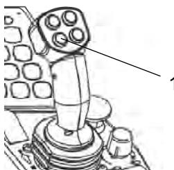
Рис. Рычаг прямого/обратного хода
