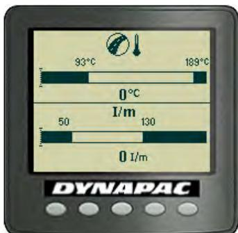
Рис. Экран температуры асфальта/ударного измерителя
