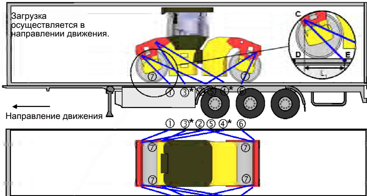
\* Если в прицепе отсутствует концевая разметка, элементы крепления могут быть зафиксированы на задней точке крепления катка.
