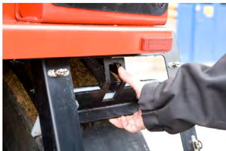
Чтобы опустить скребок, его нужно немного приподнять и нажать запирающий крюк.
