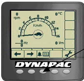
Полученные и сохранённые аварийные сигналы можно просмотреть, выбрав функцию отображения аварийных сигналов.
