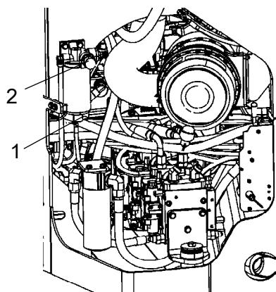
Рисунок. Топливный фильтр
