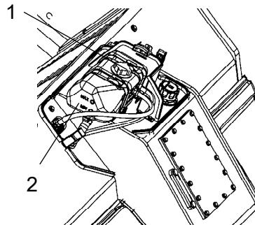
Рис. Расширительный бачок
