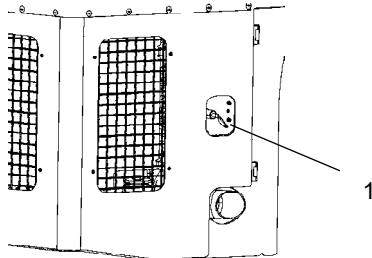
Рис. Дверца моторного отсека, правая
