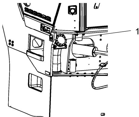
Рисунок. Стандартный бак с водой
