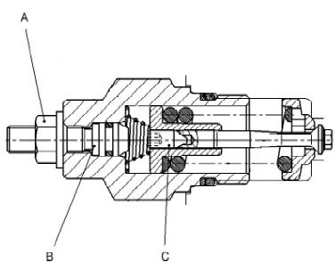
Рис. Буксировочный клапан
