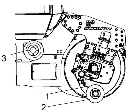
Рис. Боковой резак/уплотнитель
