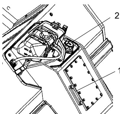
Рисунок. Гидравлический бак
