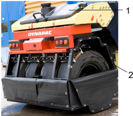
**Fig. Bastidor de ruedas**
