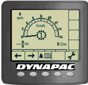
*Fig. En la pantalla se muestra la selección en el centro (posición 1, 2 o 3)*
