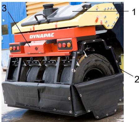
**Fig. Bastidor de ruedas**
