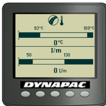
Fig. Temperatura del asfalto/Pantalla del impactómetro
