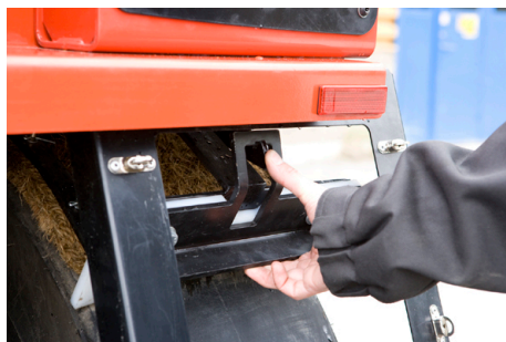
Fig. Rascadores de ruedas 1. Hojas del rascador 2. Gancho de bloqueo
