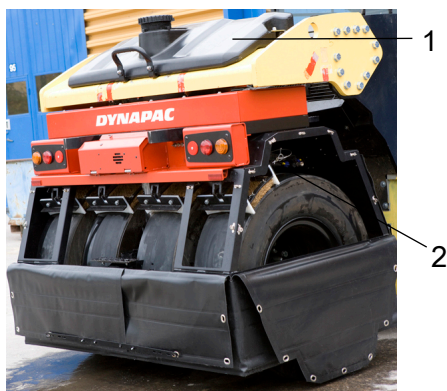
Fig. Bastidor de ruedas 1. Depósito trasero de agua 2. Boquilla de aspersión
