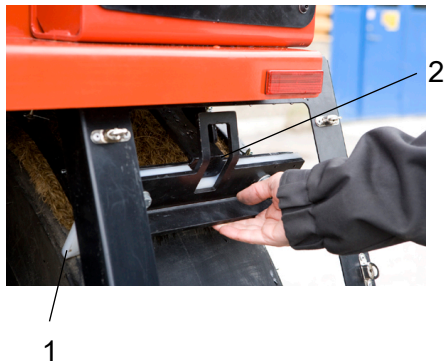
Fig. Rascadores de ruedas 1. Hojas del rascador 2. Gancho de bloqueo
