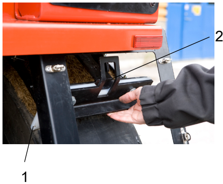
Fig. Raspadores das rodas 1. Lâminas raspadoras 2. Trava
