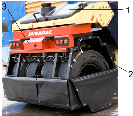
Fig. Berço das rodas 1. Tanque de água traseiro 2. Bico aspersor 3. Sistema aspersor
