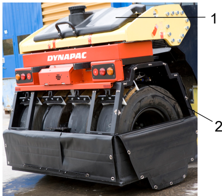
Fig. Berço das rodas 1. Tanque de água traseiro 2. Bico aspersor
