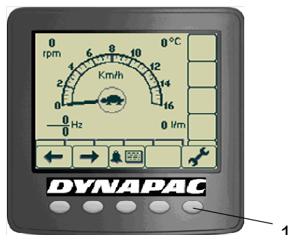
Hlavní/pracovní obrazovka s tlačítky výběru nabídky (1)
