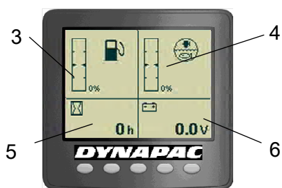
Obr. Stavová obrazovka 3. Hladina paliva 4. Hladina vody 5. Měřič motohodin 6. Voltmetr
