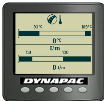
Fig. Schermata Temperatura asfalto/Misuratore compattazione
