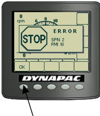
Quando viene attivato un allarme motore, esso viene visualizzato sul display.
