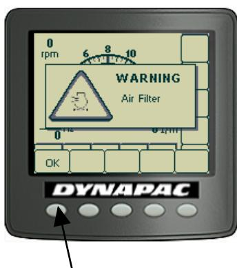
При возникновении аварийного сигнала, касающегося работы машины, на дисплее отображается предупреждение с информацией в виде текстового сообщения.
