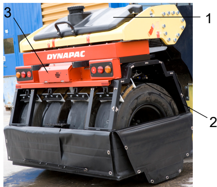
Rys. Rama koła 1. Tylny zbiornik wody 2. Dysza zraszacza 3. Układ zraszaczy
