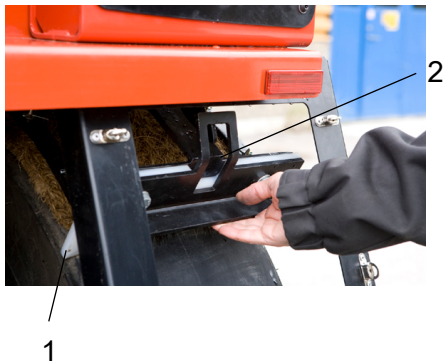
Rys. Skrobaki kół 1. Łopatki skrobaka 2. Zaczep blokujący
