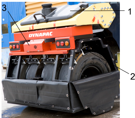
Fig. Hjulställ 1. Bakre vattentank 2. Sprinklermunstycke 3. Sprinklersystem
