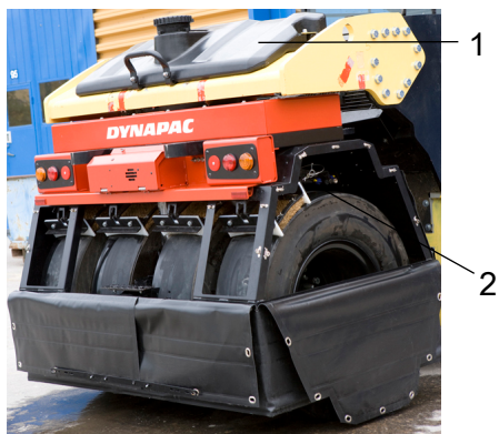
Fig. Hjulställ 1. Bakre vattentank 2. Sprinklermunstycke
