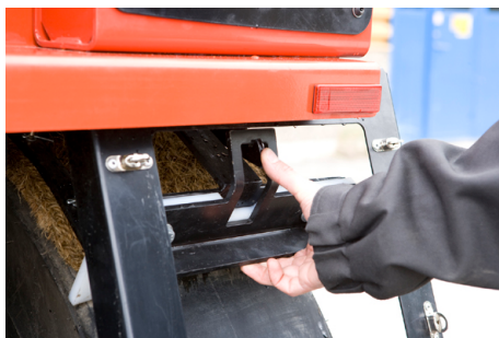
Fig. Däckskrapor 1. Skrapblad 2. Låskrok
