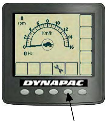
В нижней части экрана отображается значок необходимости обслуживания.
