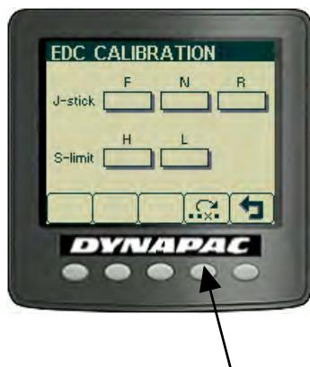
**«EDC CALIBRATION» (Калибровка электронного управления)**
