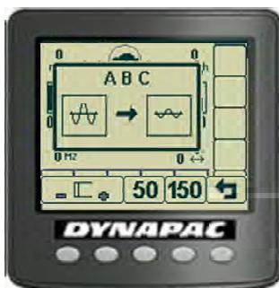
Датчик, встроенный в опору коренного подшипника, регистрирует вибрацию вальца, передавая данные на блок процессора, который их анализирует.
