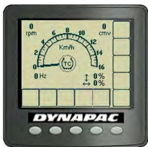
Рис. На дисплее показано включенное/отключенное состояние противопротивобуксовочной системы
