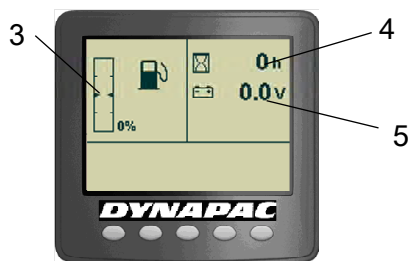
Fig. Statusbild 3. Bränslenivå 4. Drifftimräknare 5. Voltmätare
