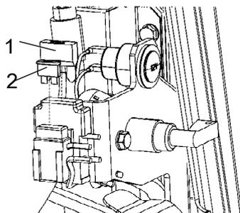
Fig. Fusíveis, compartimento do motor
