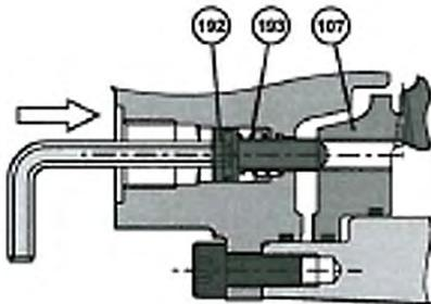
2. Pressione os parafusos (192) para dentro para comprimir as molas (193) de modo a que o parafuso alcance a rosca interior do travão (107).
