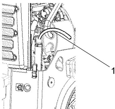
Fig. Reservatório hidráulico
