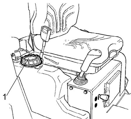
**Fig. Depósito de água**
