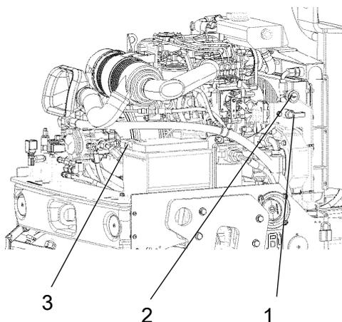
Fig. Compartimento da bateria
