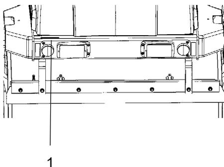
**Fig. Numéro PIN sur le cadre avant**
