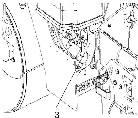
Desserrer le bouchon rouge (3) et retirer la pièce du filtre (4).
