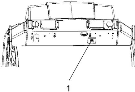
**Fig. Réservoir à eau**
