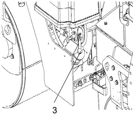
**Fig. Filtro dell'olio idraulico.**
