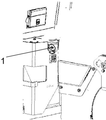
**Fig. Serbatoio del carburante**
