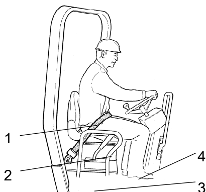
Fig. Førerstol 1. Setebelte 2. Vernerekkverk 3. Gummielement 4. Sklisikring
