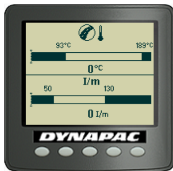
Rys. Temperatura asfaltu/Ekran uderzeniometra
