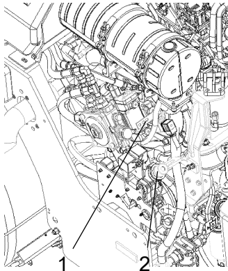
Fig. Compartiment moteur 1. Levier de manoeuvre AV/AR 2. Bouchon du réservoir hydraulique
