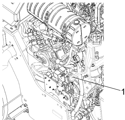
Fig. Vano motore 1. Rabbocco dell'olio idraulico
