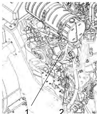
Fig. Compartimento del motor 1. Palanca de avance/retroceso 2. Tapa del combustible
