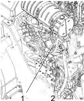
Fig. Compartimento del motor 1. Palanca de avance/retroceso 2. Tapa del combustible
