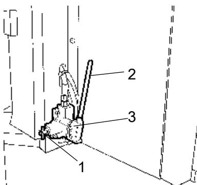
Рис. Насос отключения тормоза
