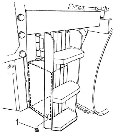
Рис. Бак гидравлической системы
