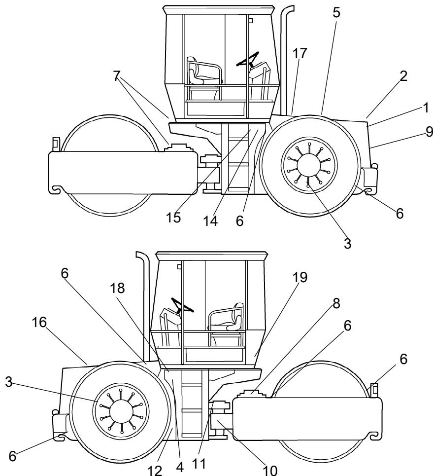
Рис. Позиции проведения технического обслуживания
