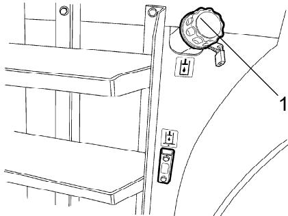
Рис. Бак гидравлической системы
