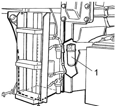
Рис.. Фильтр гидравлической жидкости
