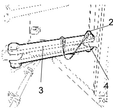
Рис. Шарнирное сочленение в заблокированном положении
