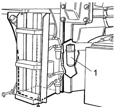
Рис.. Фильтр гидравлической жидкости
