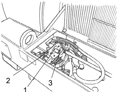
Рис. Аккумуляторный отсек в балке переднего моста
