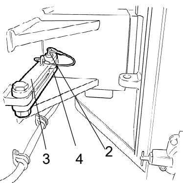
Рис. Шарнирное сочленение в заблокированном положении
