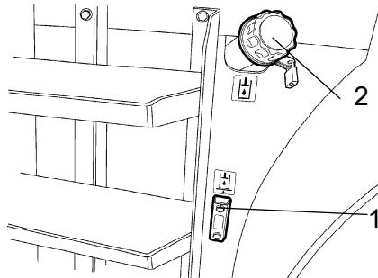
Рис. Бак гидравлической системы
