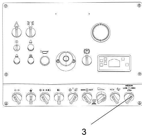
Рис. Регулятор оборотов двигателя
