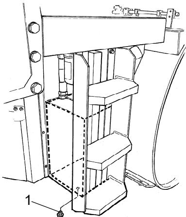
Рис. Бак гидравлической системы
