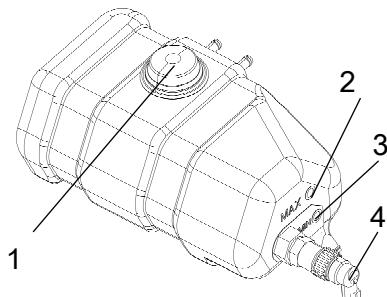
Рис. Расширительный бачок
