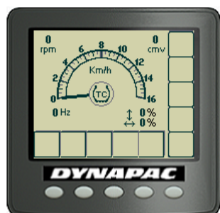
Afb. Het display heeft aan of de TC (anti-spin) geactiveerd is of niet.
