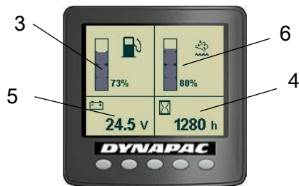
Afb. Statusscherm 3. Brandstofpeil 4. Urenteller 5. Voltmeter 6. Ureumpeil
