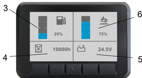
Abb. Statusansicht 3. Kraftstoffniveau 4. Betriebsstundenzähler 5. Voltmeter 6 Harnstofffüllstand
