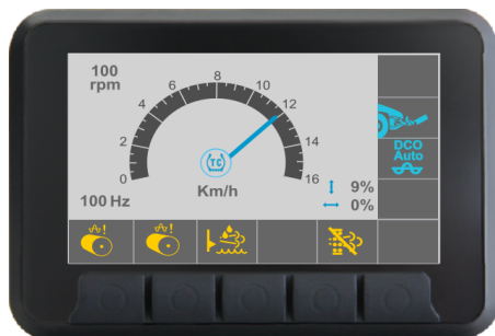
Abb.: Das Display zeigt an, ob TC (Anti-Spin) ein- oder ausgeschaltet ist.
