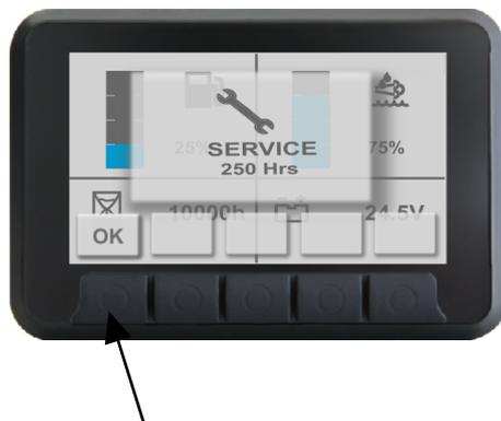
Un messaggio di assistenza (assistenza periodica) è visualizzato sul display 15 ore prima del primo intervento di assistenza (50 h).
