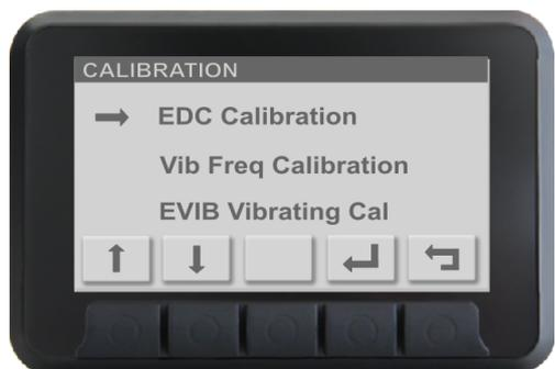
"EDC Calibration" (calibrazione EDC) consente di calibrare il joystick e il potenziometro della velocità.
