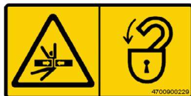
**4700908229****Attenzione - Rischio di schiacciamento, utilizzare il dispositivo di bloccaggio**
