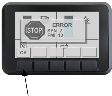
Quando viene attivato un allarme motore, esso viene visualizzato sul display.
