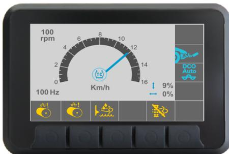
**Fig. Il display mostra se il TC (anti-rotazione) è attivato o disattivato**
