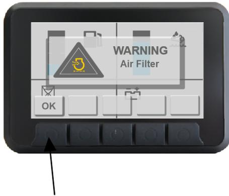
Quando viene attivato un allarme macchina, esso viene visualizzato sul display accompagnato da un testo di avvertenza che lo descrive.
