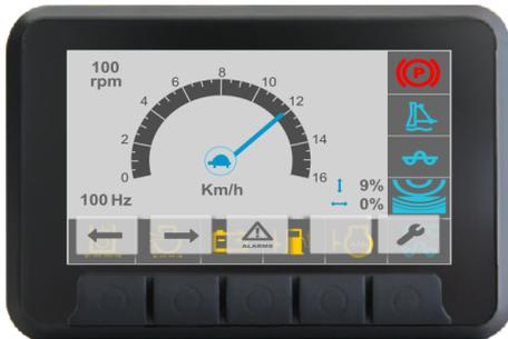
**Fig. Il display mostra al centro la selezione (tartaruga, rotazione tamburo, rotazione ruota o lepre).**
