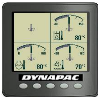
Rys. Ekran temperatury
