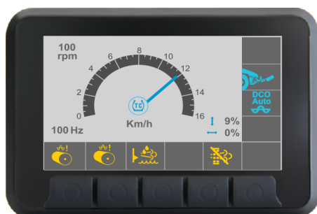
Fig. O ecrã indica se o TC (anti-patinagem) está activado ou desactivado
