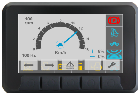
Fig. O ecrã apresenta a selecção no centro (tartaruga, patinagem do rolo, patinagem da roda ou lebre).
