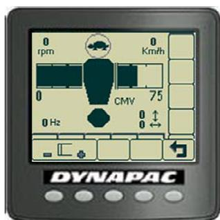
Em segundo lugar, o ABC desliga as vibrações e emite uma mensagem para o operador continuar a compactação com uma definição de amplitude da vibração inferior ou, se estiver disponível a frequência variável, reduz a frequência das vibrações.
