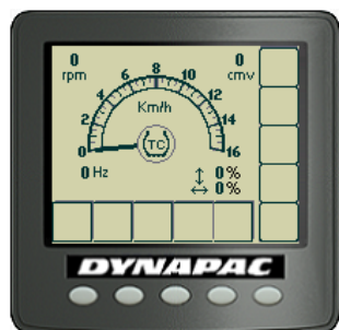
Fig. Ecranul afișează dacă TC (anti-patinare) este activat sau decuplat.
