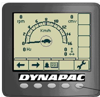
Fig. Fereastră principală/Fereastră de lucru cu butoane de selectare a meniului (1)
