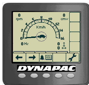
Fig. Afișajul indică selecția în centru (broască țestoasă, rotație tambur, rotație roată sau iepure).
