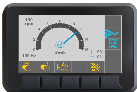
Obr. Displej zobrazuje, či je TC (systém proti pretočeniu) aktivovaný alebo odpojený
