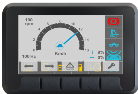
Obr. Hlavné zobrazenie/pracovné zobrazenie s tlačidlami výberu ponuky (1)
