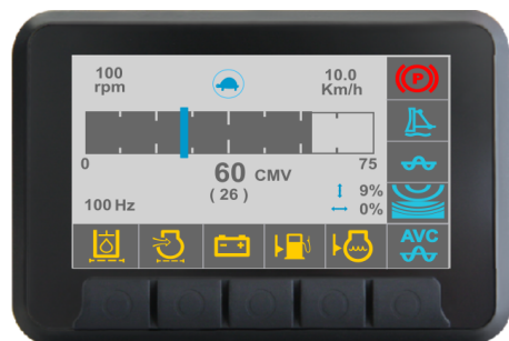
Obr. Zobrazenie meradla zhutnenia (zobrazenie CMV)
