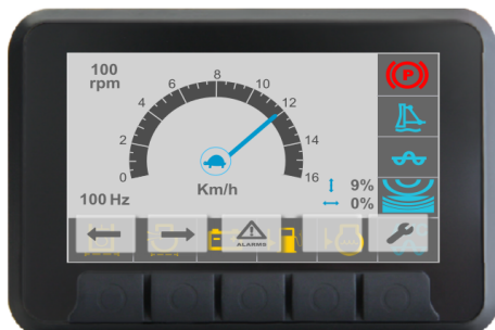
Obr. Voľba sa zobrazí v strede displeja (korytnačka, točenie bubna, točenie kolesa alebo zajac).
